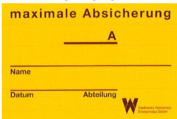
Abb. 4: Angabe der Nennstromstärke der HA-Sicherung
